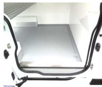
Porte latérale avec protection de seuil inox.
